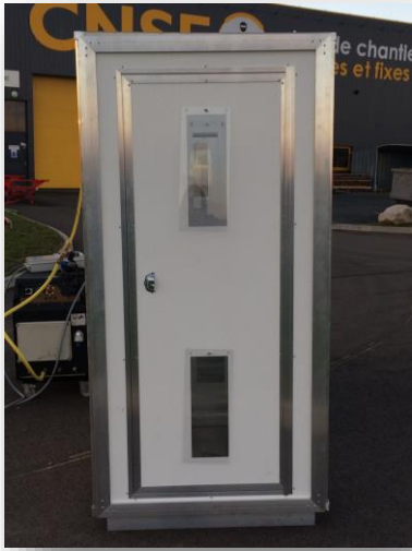
Kammer mit Klappen gemäß TRGS519
